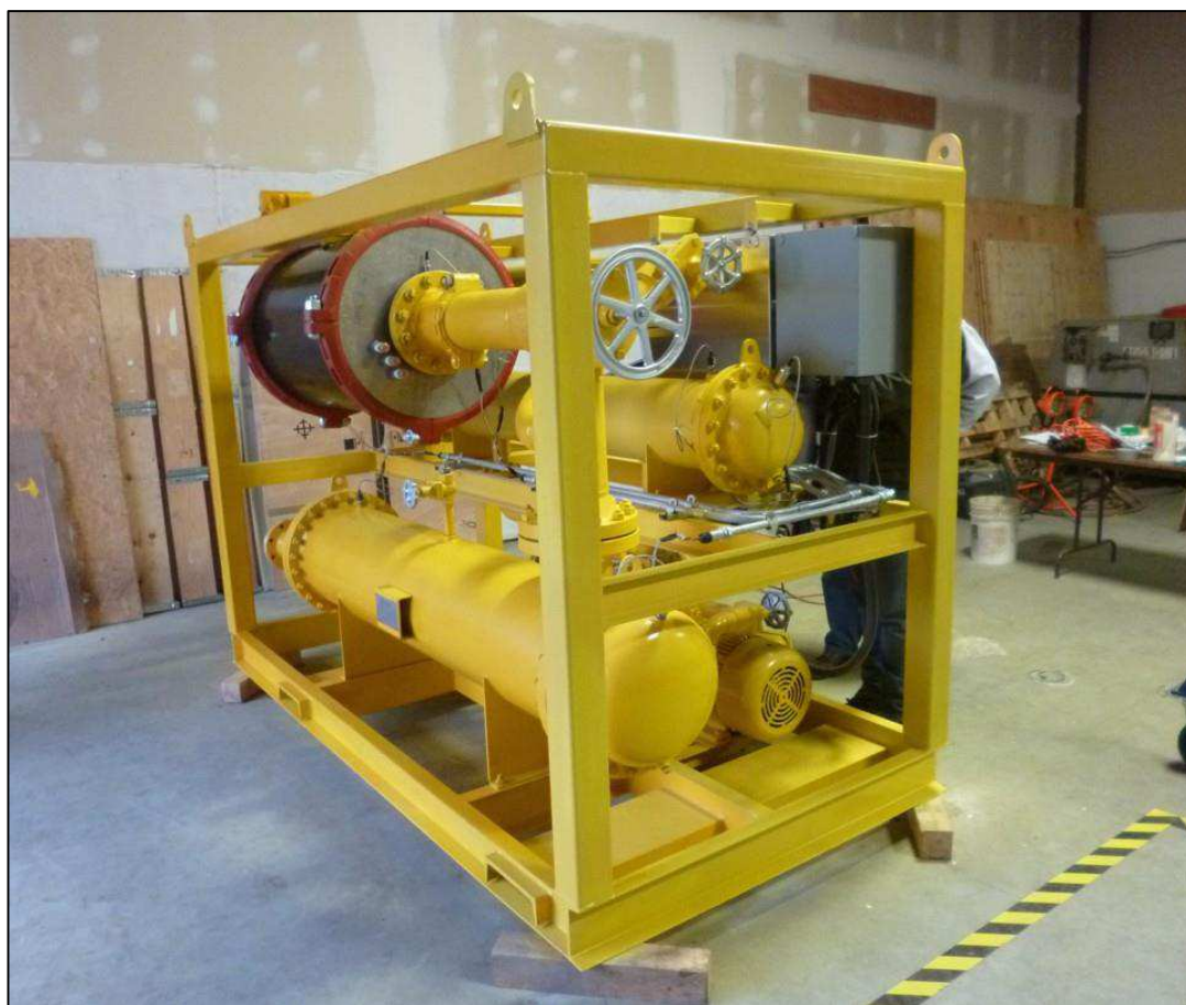
Рисунок 1.19 – ОРЦ-установка IT50 компании Infinity Turbine
