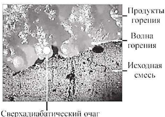
Рисунок 5.12 – Формирование капельной структуры пористой металлокерамики в волне горения системы Ni-Al
