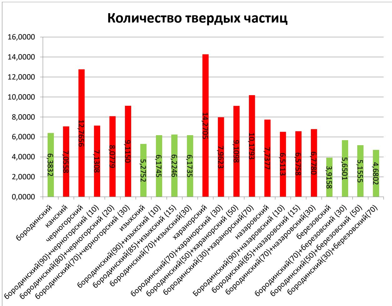
Рисунок 5.9 – Количество твердых частиц, г/с, образующихся в топке котла БКЗ-500-140 ЖШУ в результате механического недожога топлива и выбрасываемых в атмосферу в виде коксовых остатков
