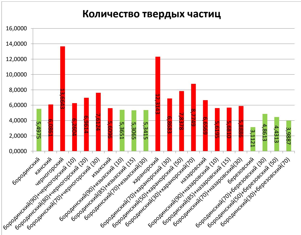
Рисунок 5.6 – Количество твердых частиц, кг/с, образующихся в топке котла БКЗ-420-140 ЖШУ в результате механического недожога топлива и выбрасываемых в атмосферу в виде коксовых остатков
