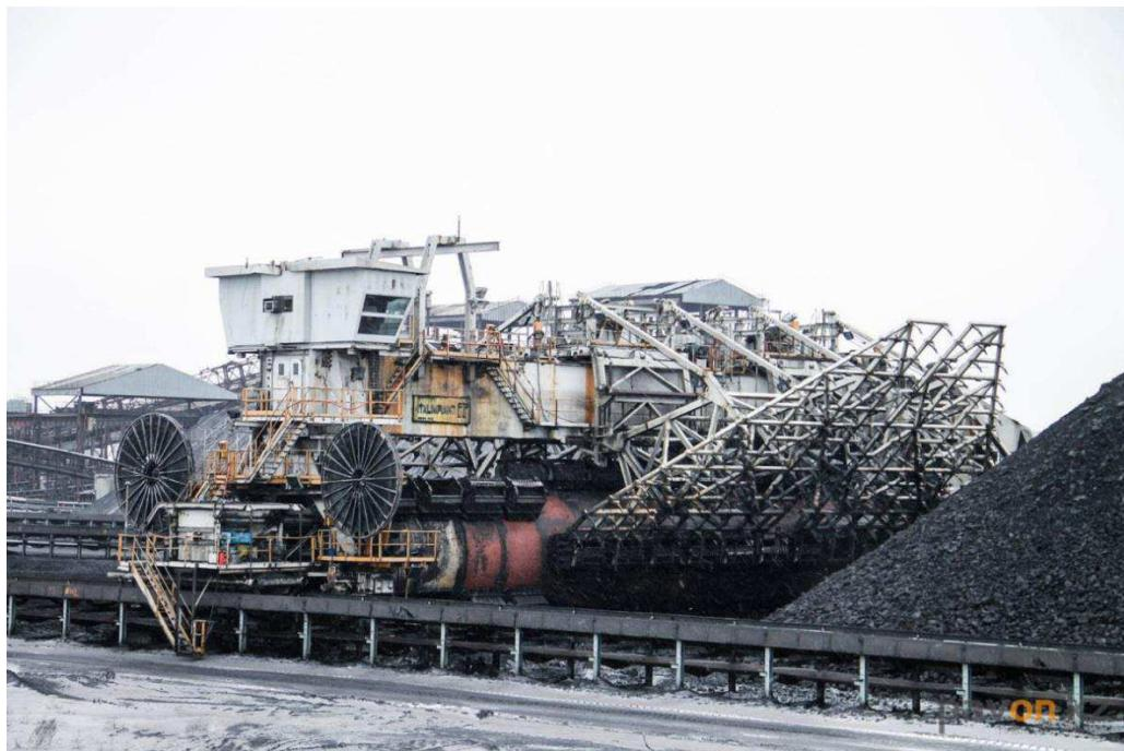
Рисунок 6.3– Усреднительно-погрузочная машина
