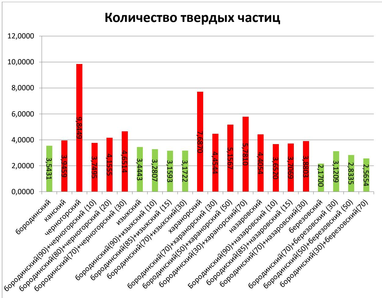
Рисунок 5.3 – Количество твердых частиц, кг/с, образующихся в топке котла БКЗ-320-140 ЖШУ в результате механического недожога топлива и выбрасываемых в атмосферу в виде коксовых остатков
