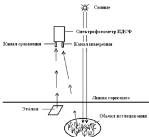
Рис. 2. Оптическая схема регистрации спектрально-отражательных характеристик посевов
