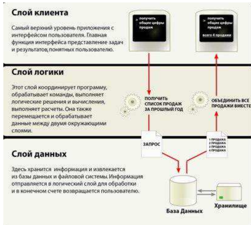
Рисунок 7 - Схема трехуровневой архитектуры
