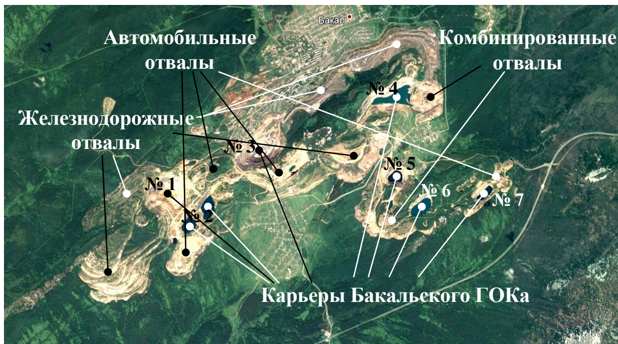
Рис. 1. Фрагмент космоснимка с объектами горнопромышленного ландшафта, образованного при ведении открытых горных работ на Бакальском ГОКе
