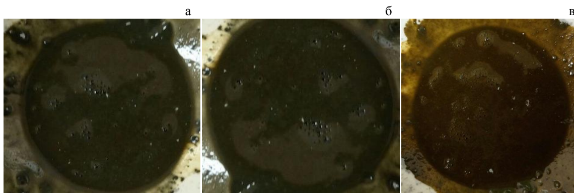
Рисунок 2 – Газовыделение смеси известняковой муки с пластифицирующими добавками а – Полипласт СП-1; б – МС-Powerflow-7951; в – Centrament N10
