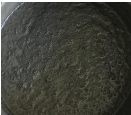
Рис.2. Самоуплотняющаяся бетонная смесь с использованием молотого известняка
