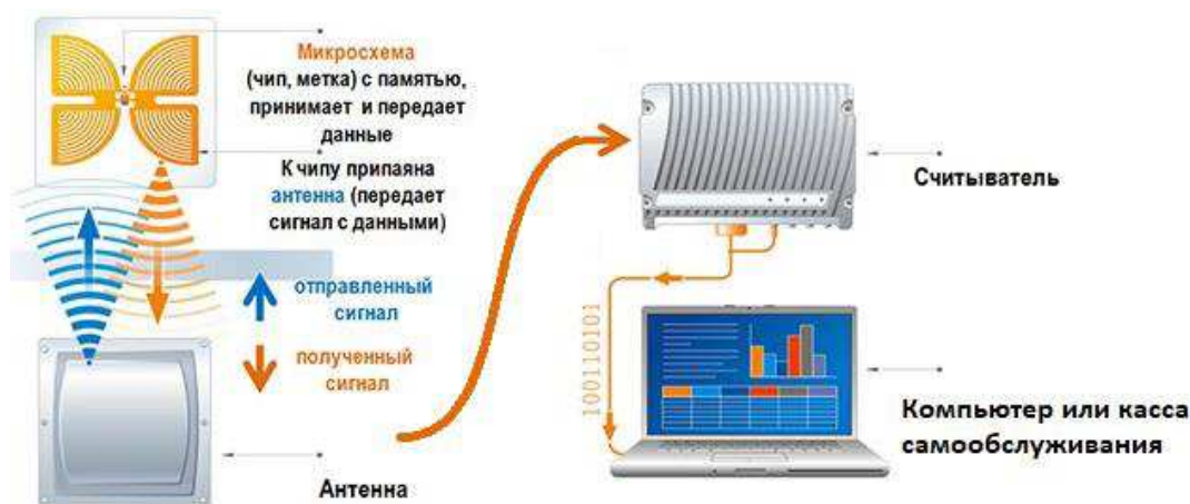
Рисунок 3 — Процесс считывания RFID-метки
