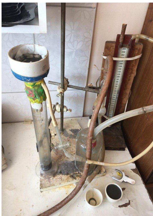
Рисунок 1 - Установка для определения удельного сопротивления осадка фильтрации.
