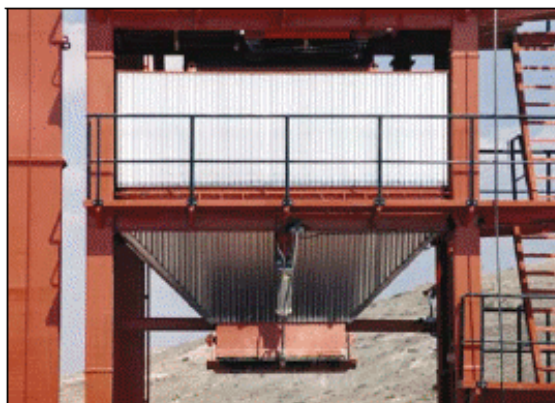
Бункер-накопитель с прямой загрузкой непосредственно под смесителем
