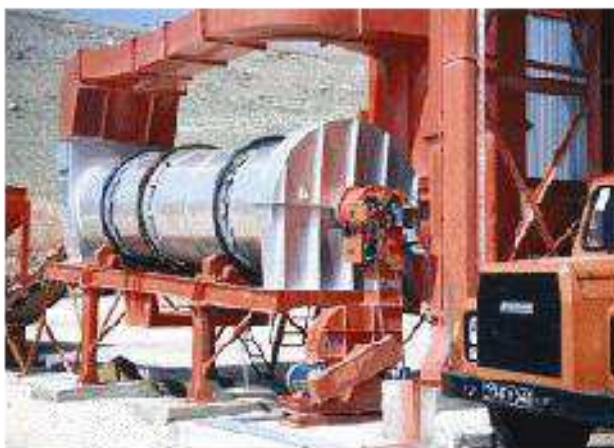
Рисунок 5 – Сушильный барабан с цепным приводом на действующем оборудовании
