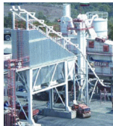
Бункер-накопитель со скиповой загрузкой и двумя выгрузными затворами
