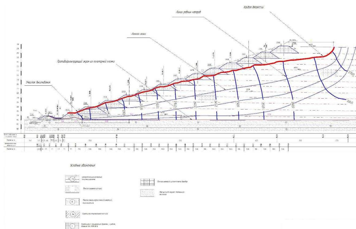
Рисунок 4 – Результат численного моделирования фильтрации карты № 3 сечения 5-5
