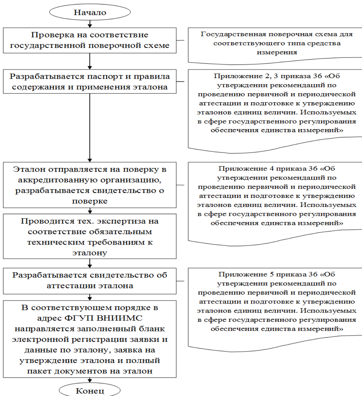
Рисунок 2 - Блок-схема процесса аттестации эталона
