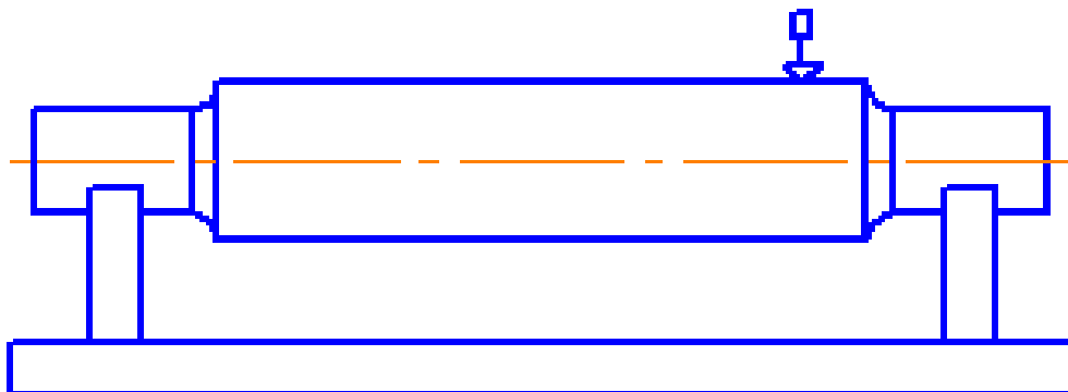
Рисунок 7 – схема стенда для измерения шероховатости
