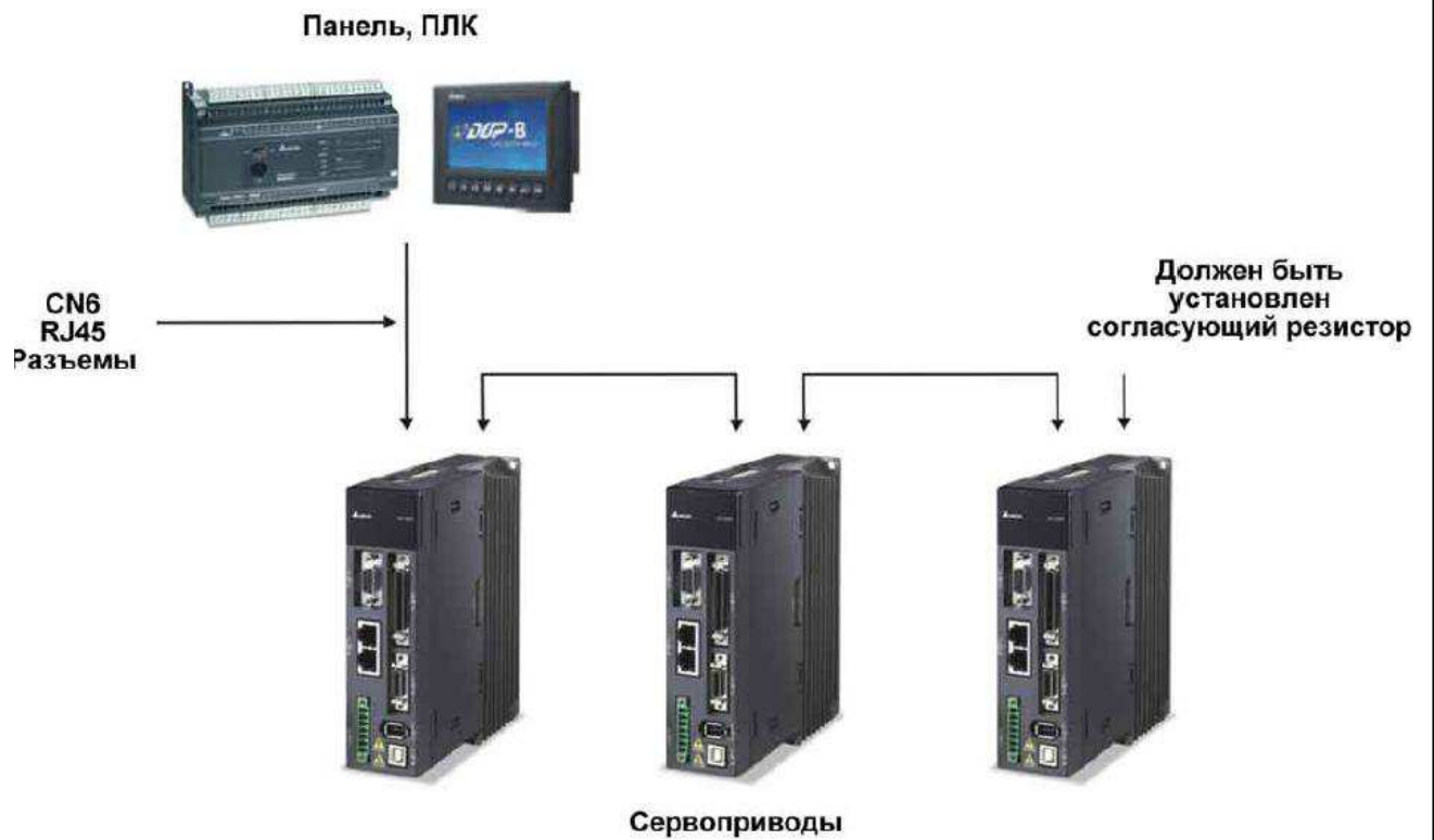
Рисунок 17 – Связь нескольких приводов по CANopen
