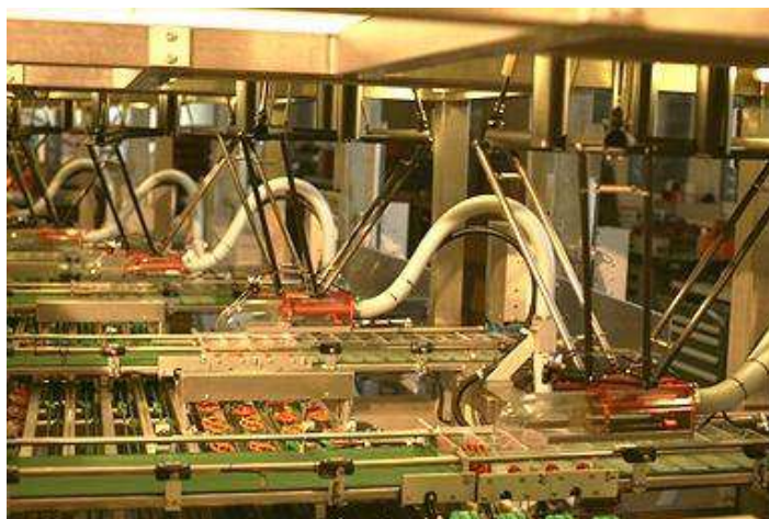
Рисунок 2 - Установка линии роботов Line-Placer компании Demarex для упаковки хлебобулочных изделий в промышленной пекарне
