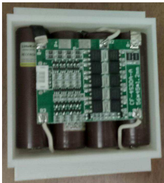
Рисунок 3.3 – Сборка группы аккумуляторных батарей
