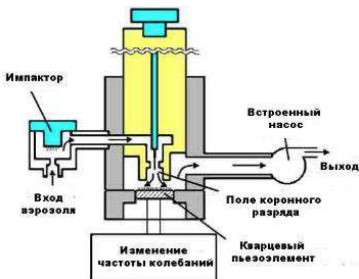
Рисунок 1.1 – Пьезобалансный метод измерения
