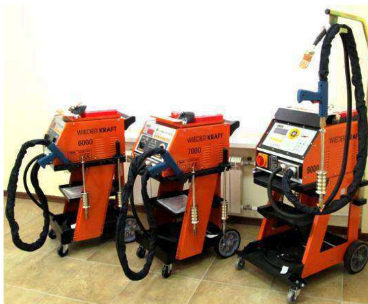
Рисунок 3.10 – Модельный ряд споттеров WIEDERKRAFT для выполнения работ по выравниванию поверхности и односторонней точечной сварки
