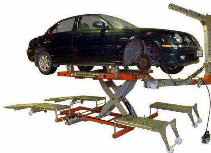
Рисунок 3.7 – Пример станда для восстановления геометрических размеров кузова или рамы - стапель Autobot XLS++
