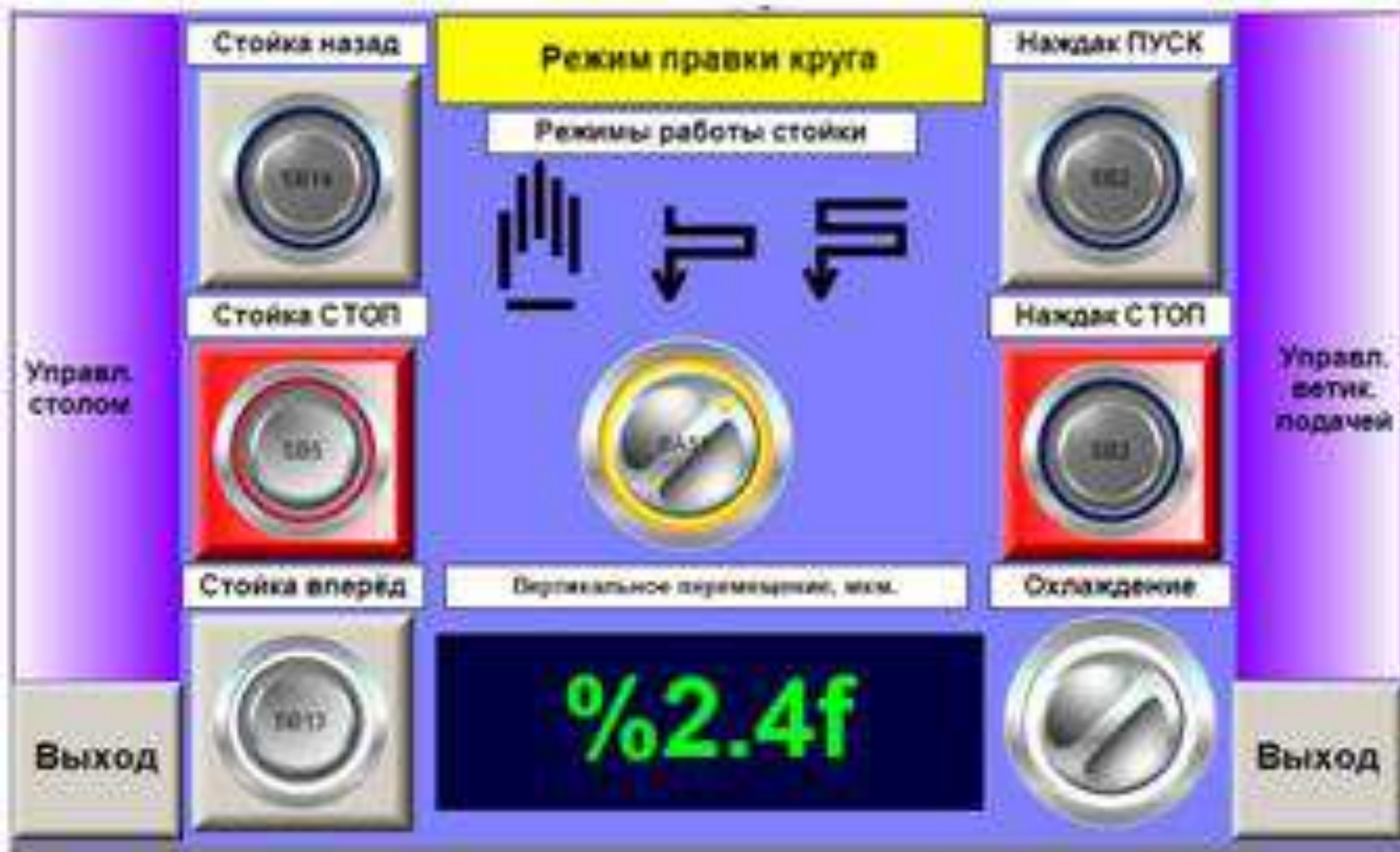
Рисунок 59 - Экраны контролера ОВЕН СПК107 лист 2: управления механизмами стойки.
