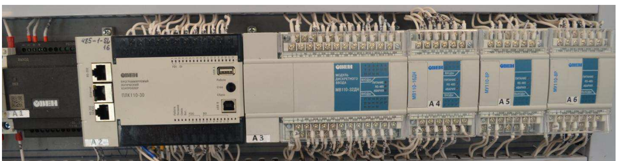
Рисунок 43-Фотография контролера с модулями расширения
