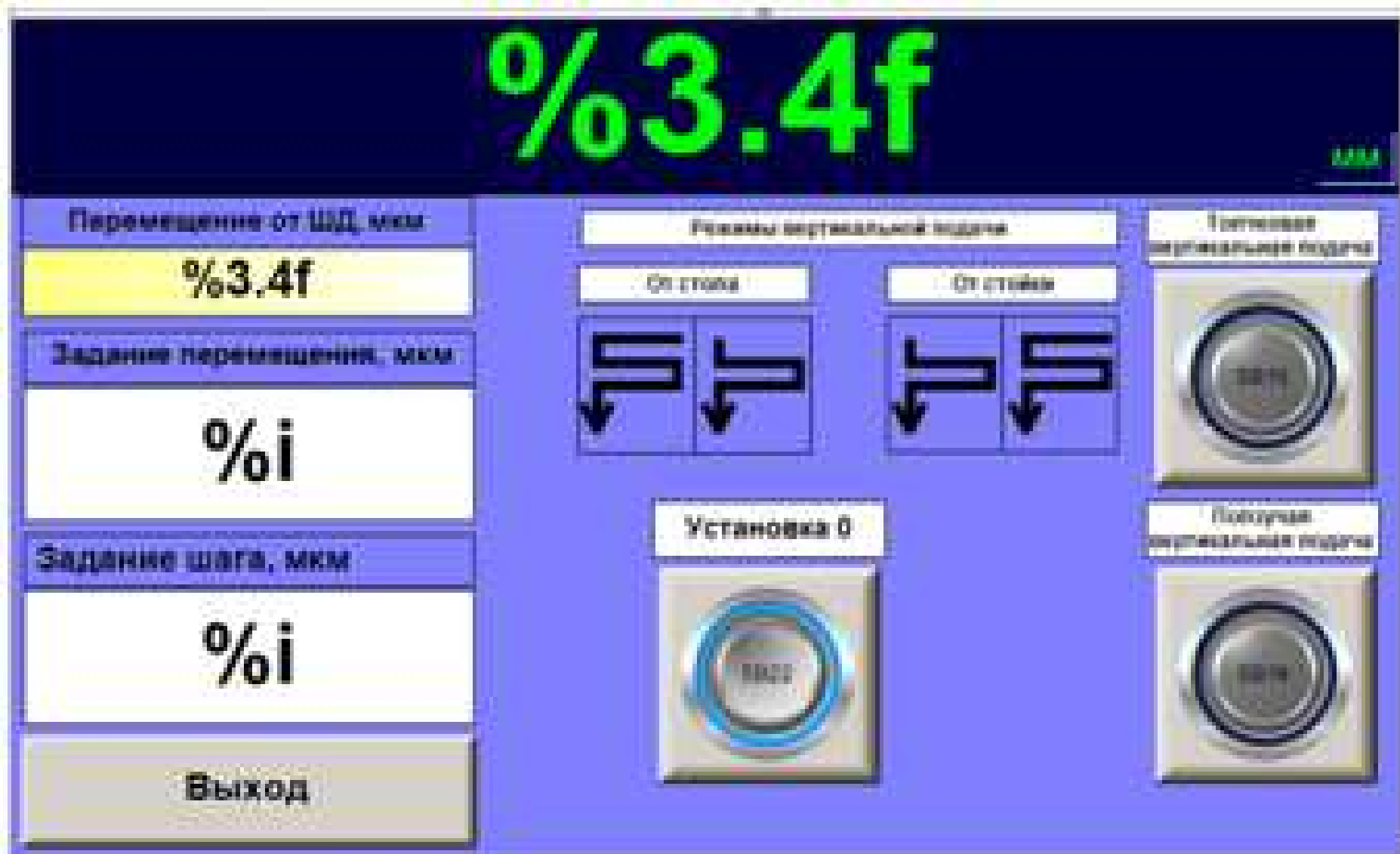
Рисунок 62 - Экраны контролера ОВЕН СПК107 лист 5: параметры режима вертикальной подачи ЭКРАН 1.
