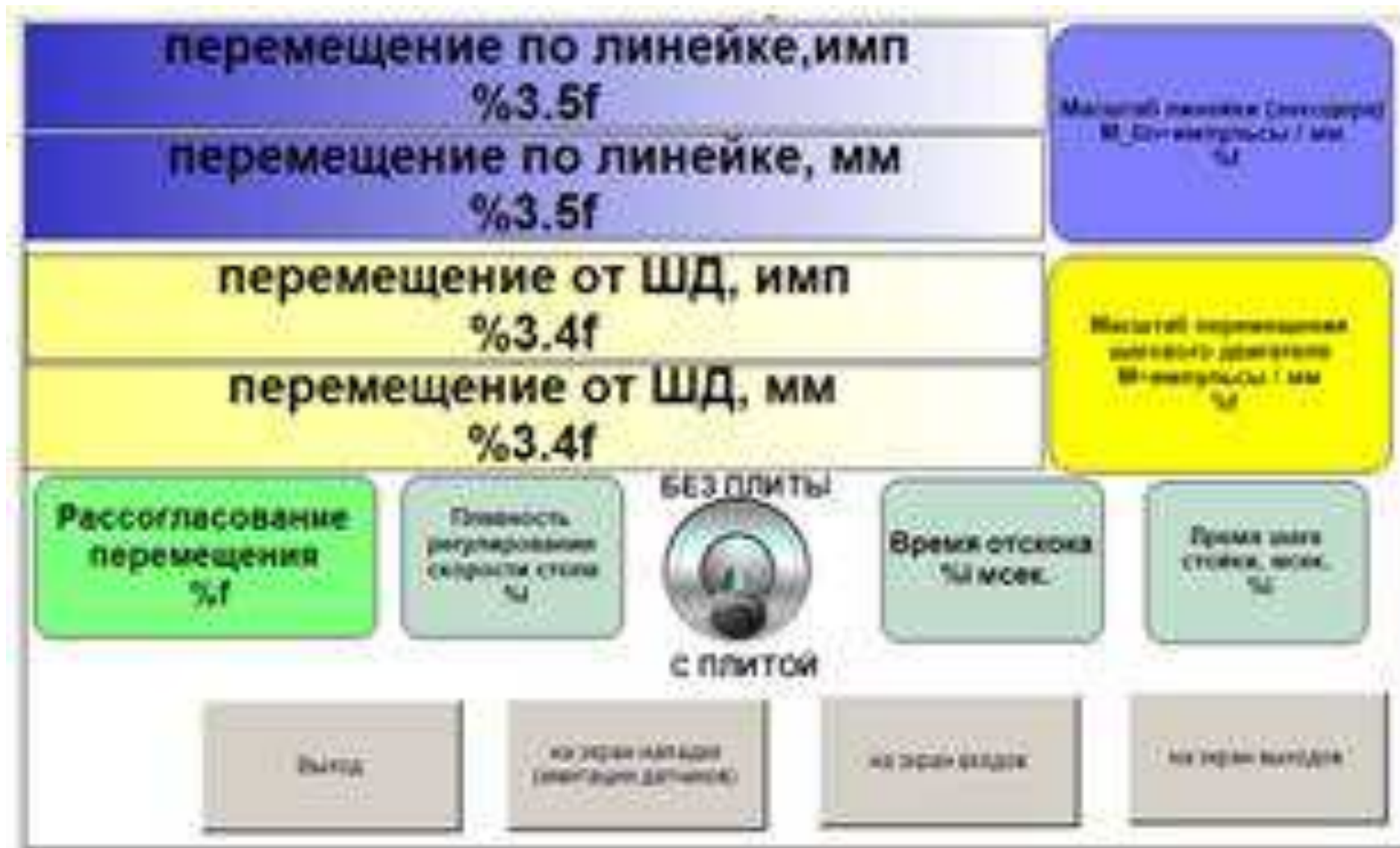
Рисунок 61 - Экраны контролера ОВЕН СПК107 лист 4: управления перемещением стойки.
