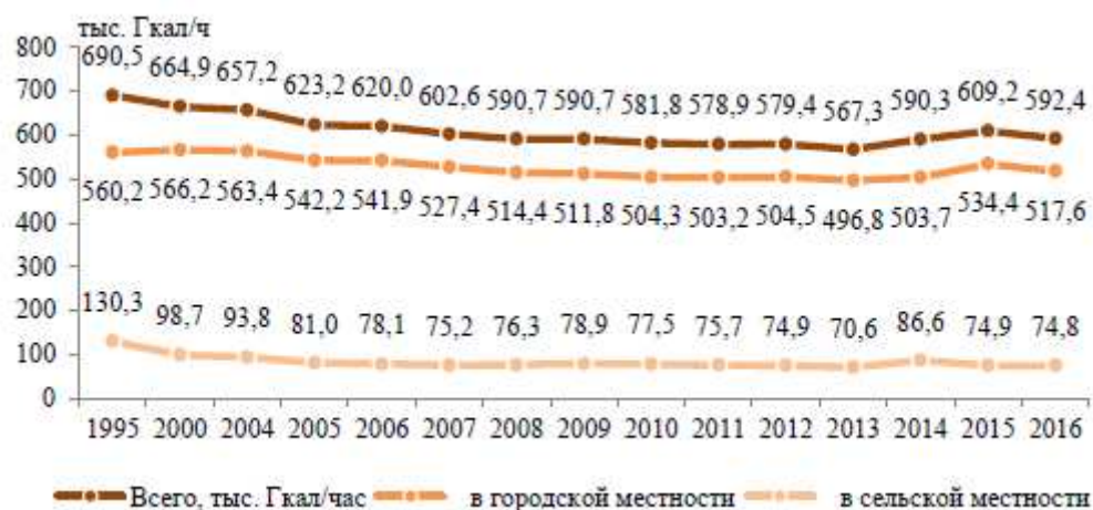
Рисунок 1.1 -Суммарная тепловая мощность коммунальных котельных в период с 1995 по 2016 гг.
