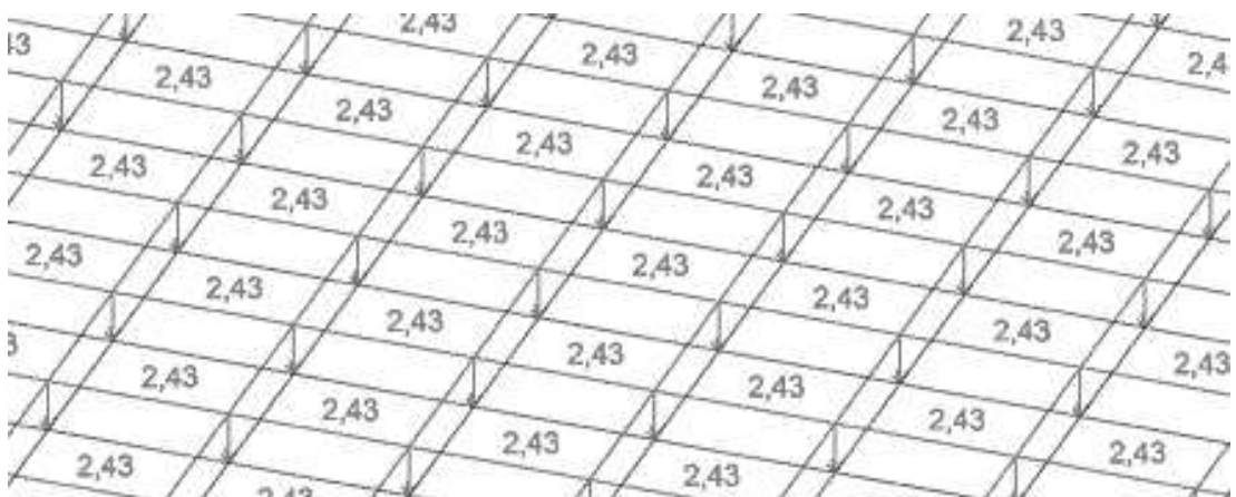
Рисунок 2.19 – Фрагментация загрузки от веса перегородок
