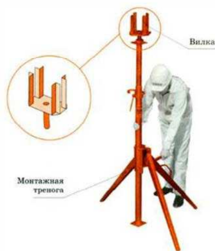
Рисунок 4.1 – Установка стойки и треноги
