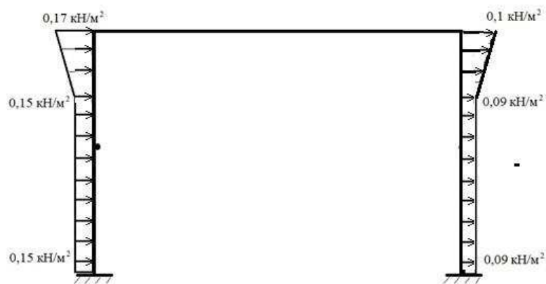
Рисунок 2.2 – Схема приложения ветровой нагрузки
