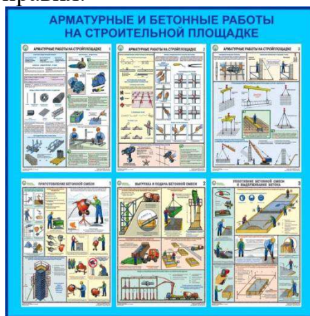
Рисунок 5.2 – Безопасность труда при производстве бетонных работ
