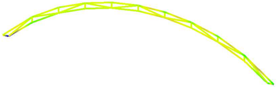
Рисунок 2.8– Эпюра M_y от сочетания нагрузок
