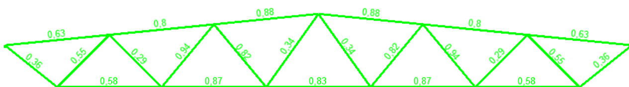
Рисунок 2.15 – Коэффициенты использования несущей способности элементов фермы
