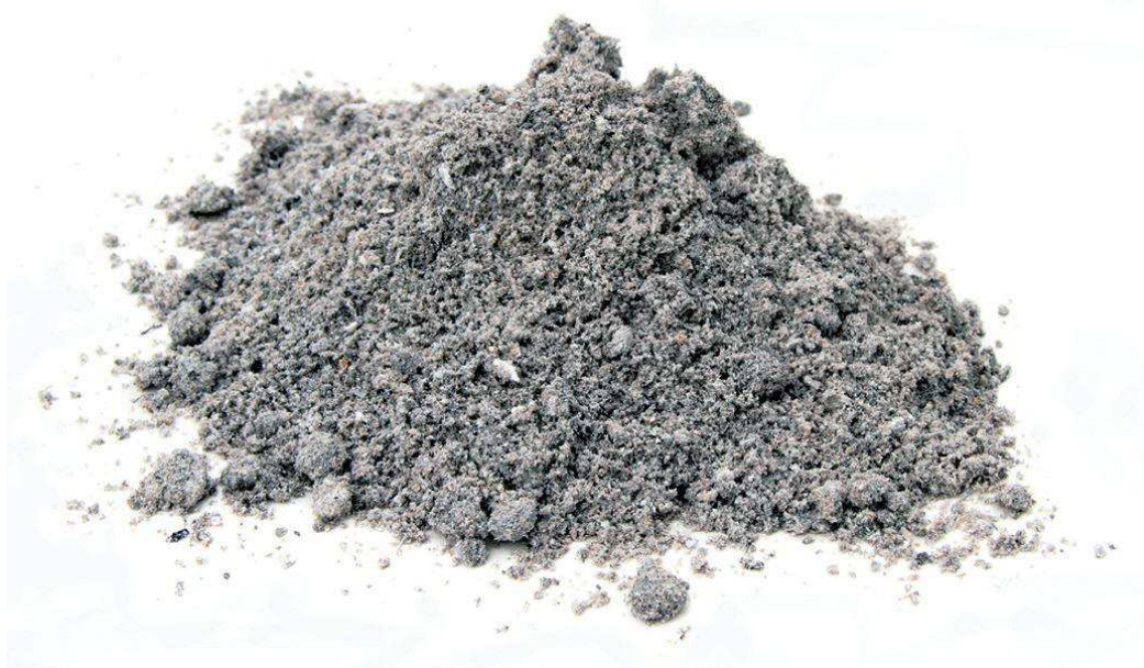
Рисунок 1 - Внешний вид золошлаковой смеси
