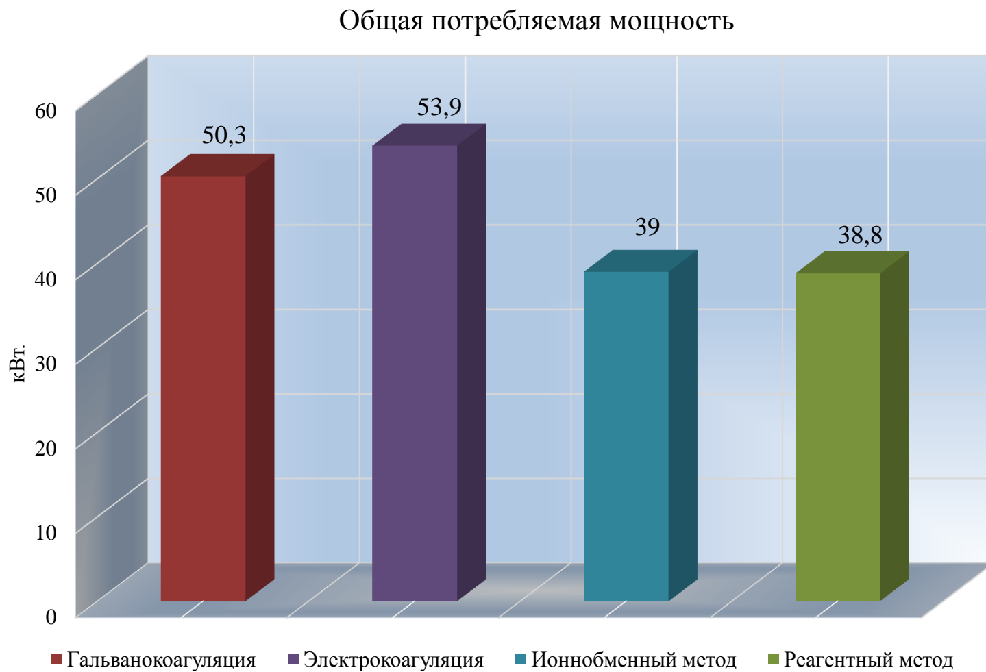
Рисунок 5.2 – Сравнительная гистограмма общей потребляемой мощности схем очистки металлосодержащих сточных вод
