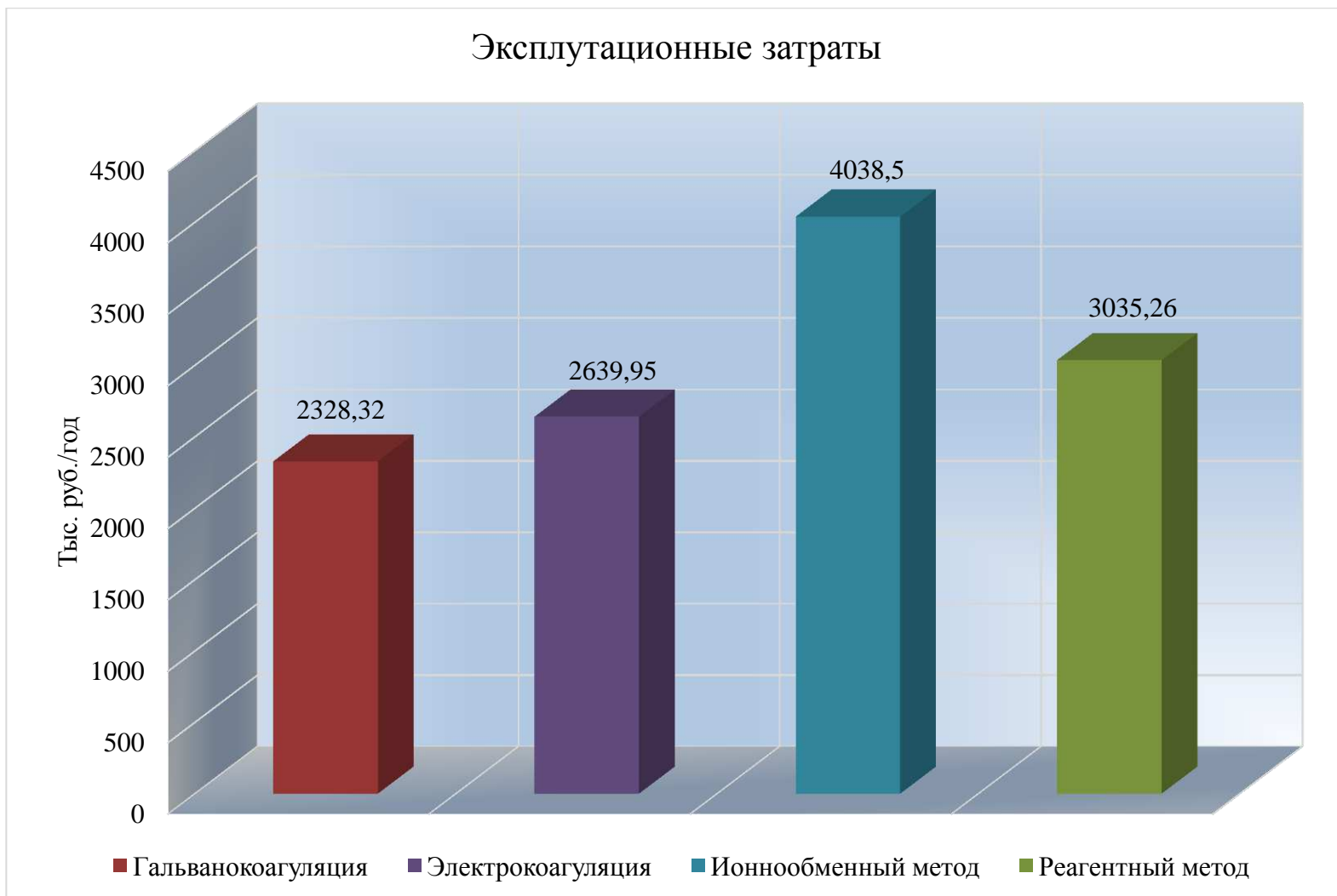
Рисунок 5.3 – Сравнительная гистограмма эксплуатационных затрат схем очистки металлосодержащих сточных вод
