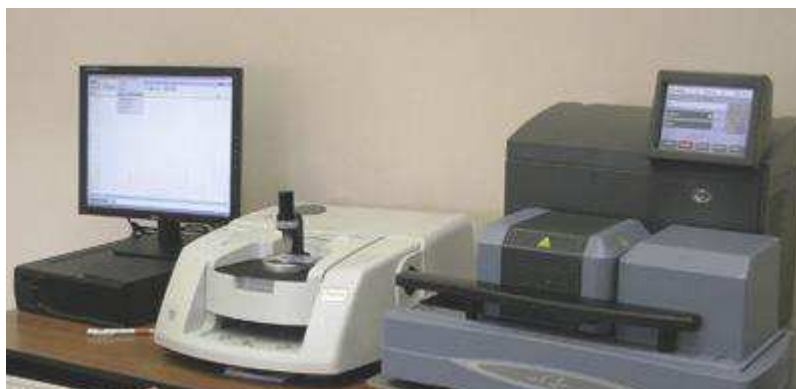
Рисунок 3.2 – ИК-Фурье спектрометр Nicolet 380 совместимый с термоанализатором SDT Q600
