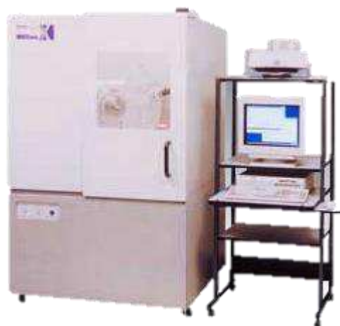
Рисунок 3.1 – Рентгеновский дифрактометр Shimadzu XRD-7000S
