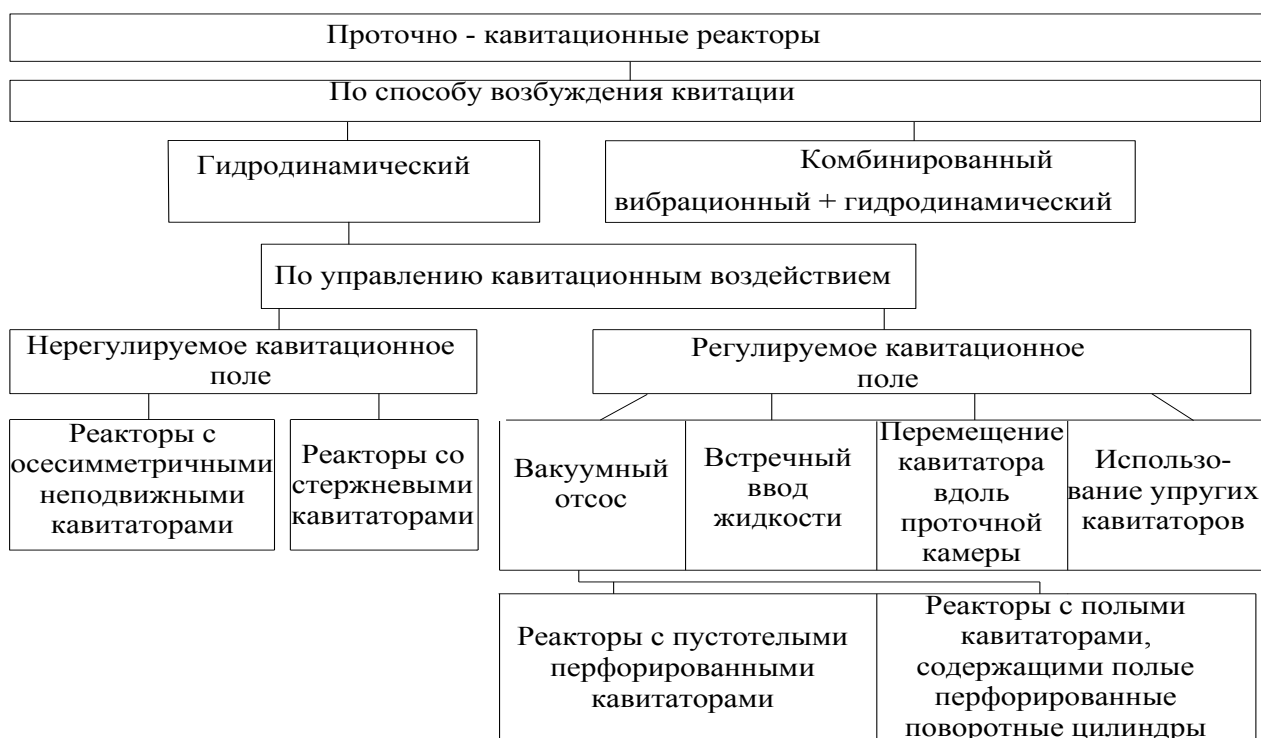
Рисунок 1.1 – Классификационная схема проточно-кавитационных реакторов
