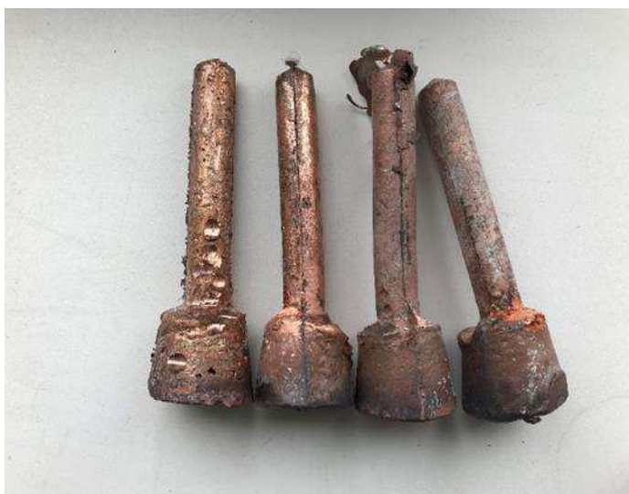
Рисунок 2.3 – Полученные в ходе плавки цилиндрические слитки
