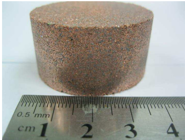
Рисунок 5 – Легирующий элемент (83 % медного порошка марки ПМС–1 и 17 % наноструктурированных частиц хрома Х99)
