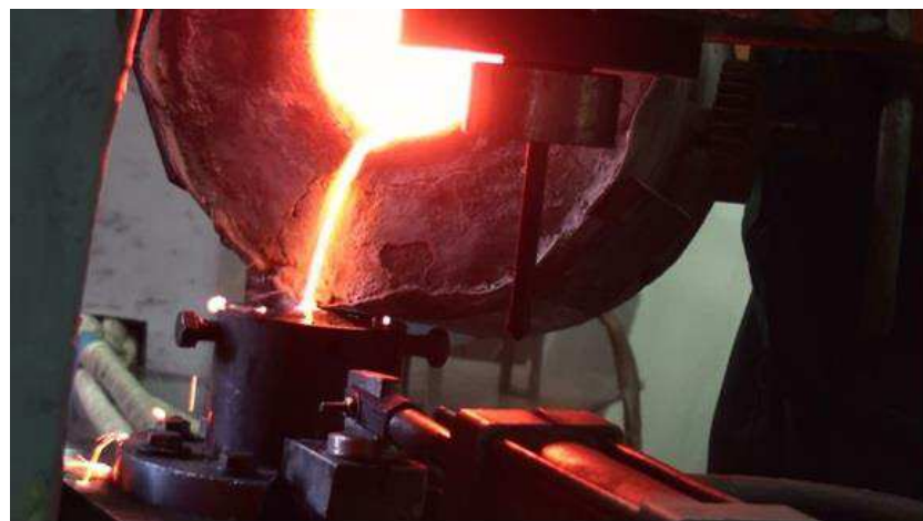
Рисунок 6 – Заливка расплавленного металла хромовой бронзы
