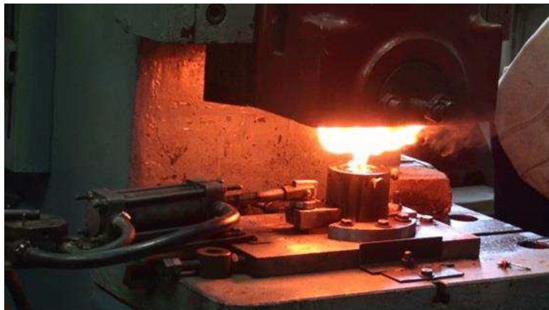
Рисунок 7 – Штамповка охлаждающего канала
