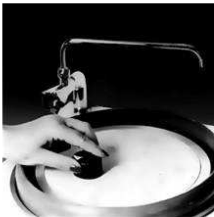
Рисунок 11 – Однодисковый станок для ручной полировки
