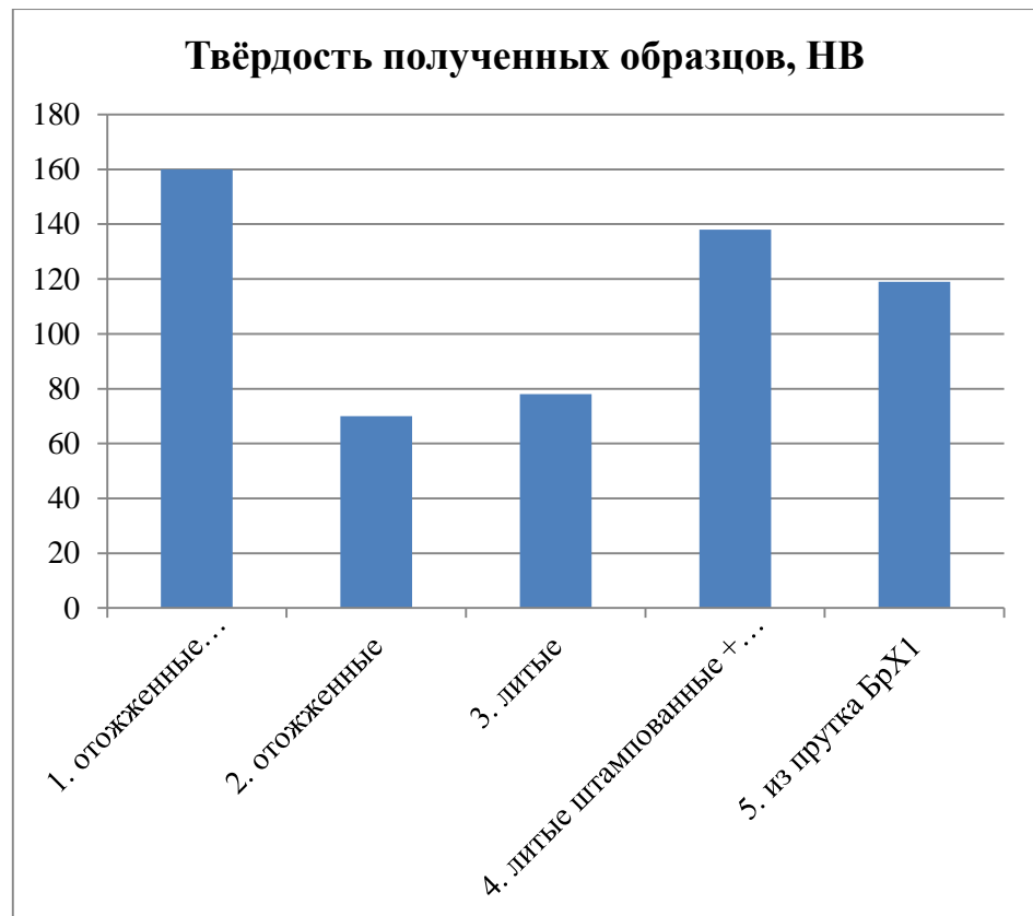
Рисунок 35 – Гистограмма твёрдости образцов, определяемых на твердомере ТБ 5004
