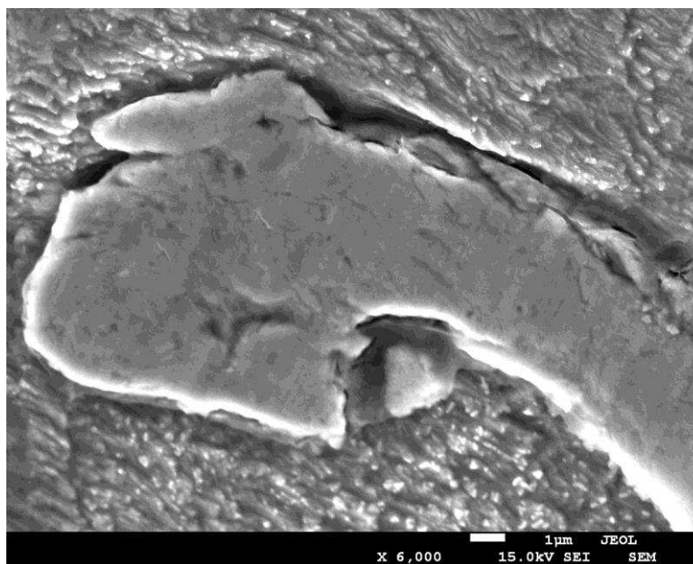
Рисунок 25 – Электронно-микроскопическое изображение микроструктуры сплава БрХ1 (x6000)
