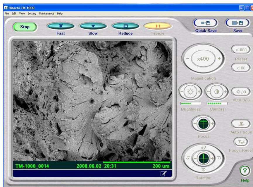
Рисунок 14 – Окно управляющей программы РЭМ HITACHI TM1000 Технические характеристики микроскопа представлены в (табл.8).
