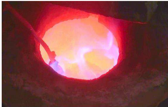
Рисунок 5 – Расплавленный металл хромовой бронзы
