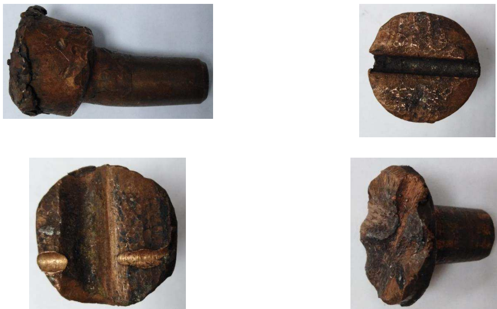
Рисунок 33 – Износ электродов контактной сварки
