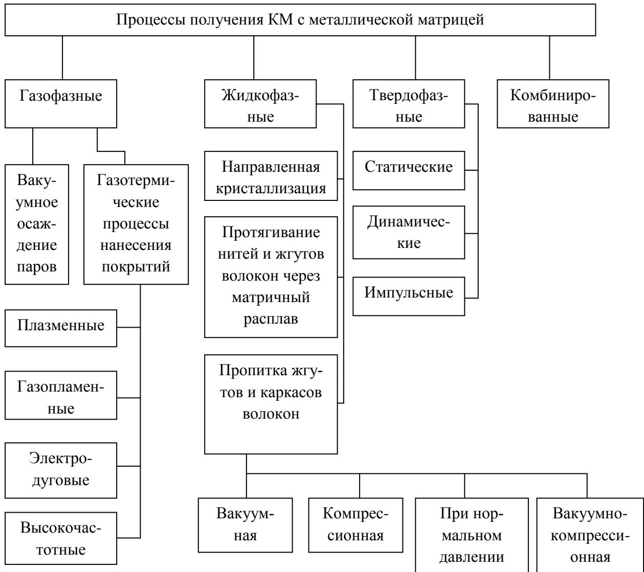
Рисунок 4 – Общая классификация процессов получения и обработки композитов с металлической матрицей
