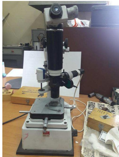
Рисунок 20 – Прибор для измерения микротвердости ПМТ-3
