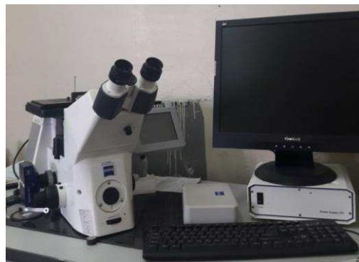
Рисунок 19 – Металлографический микроскоп *Carl Zeiss*
