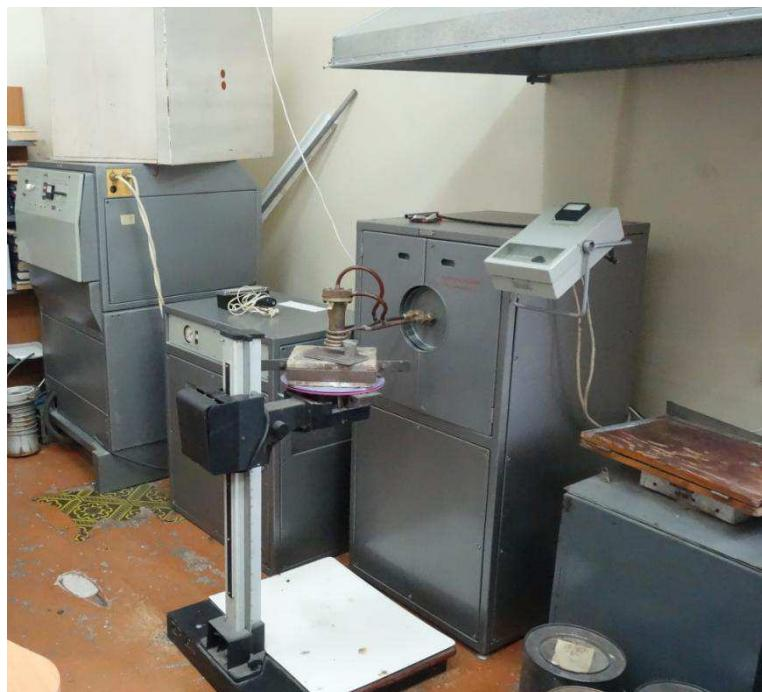
Рисунок 16 – Индукционная закалочная установка ИЗ 25/40-80
