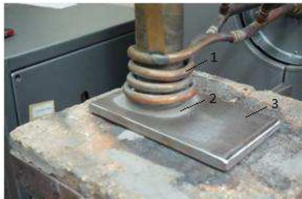
1 – индуктор, 2 – наплавляемый порошок, 3 – заготовка
