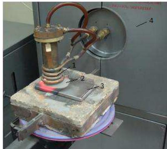
1 – индуктор, 2 – наплавляемый порошок, 3 – заготовка,
