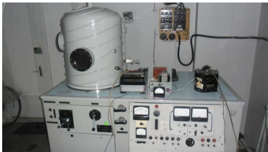
Рисунок 10 – Модифицированная установка вакуумного термического напыления
