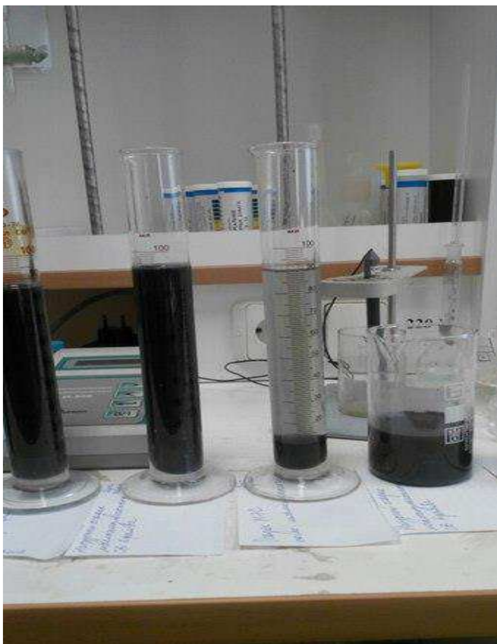
Рисунок 6 – Результат эксперимента по электрообработке осадка
