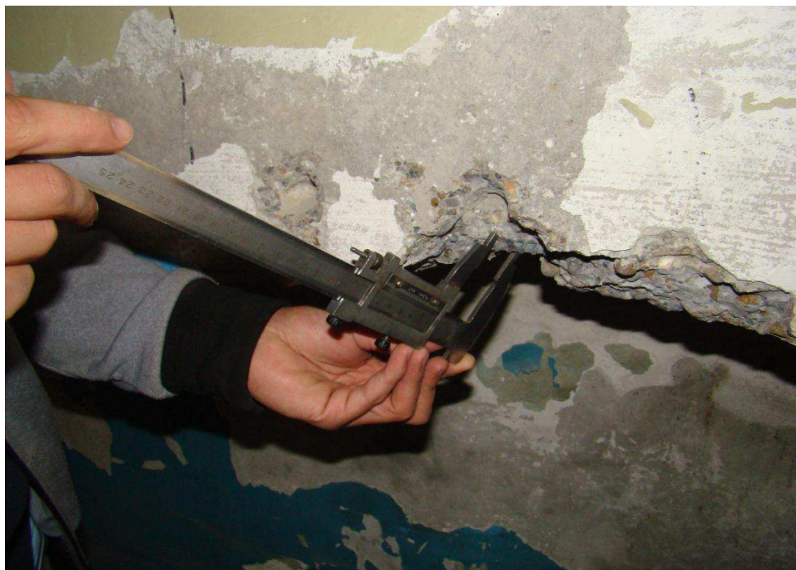
Рисунок 27 – Измерение диаметра арматуры ригеля штангенциркулем. Характерный фрагмент.
