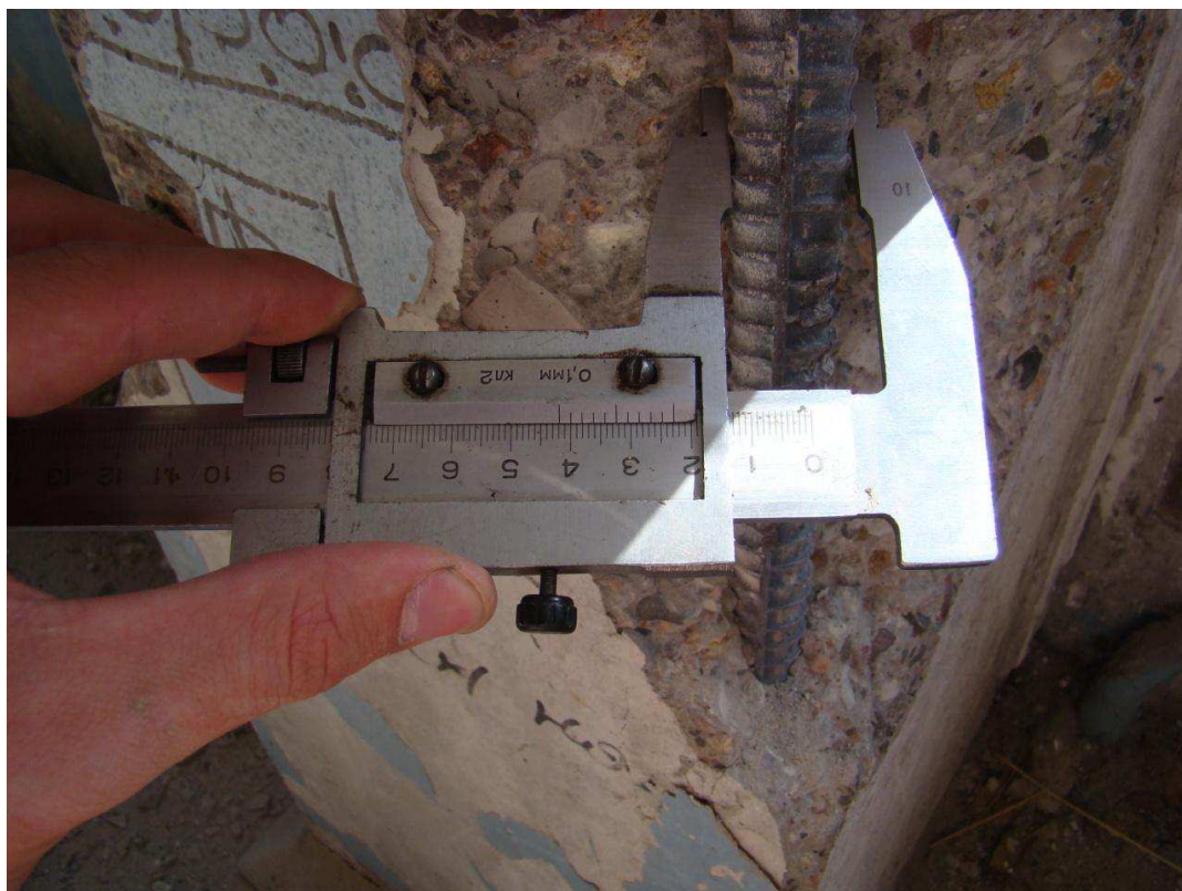
Рисунок 23 – Измерение диаметра арматуры колонны штангенциркулем. Крупный план.
