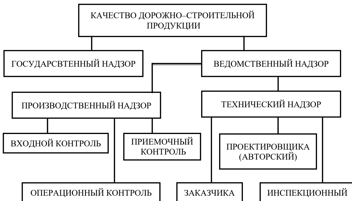
Рисунок 1 – Система контроля и управления качеством дорожно-строительной продукции
