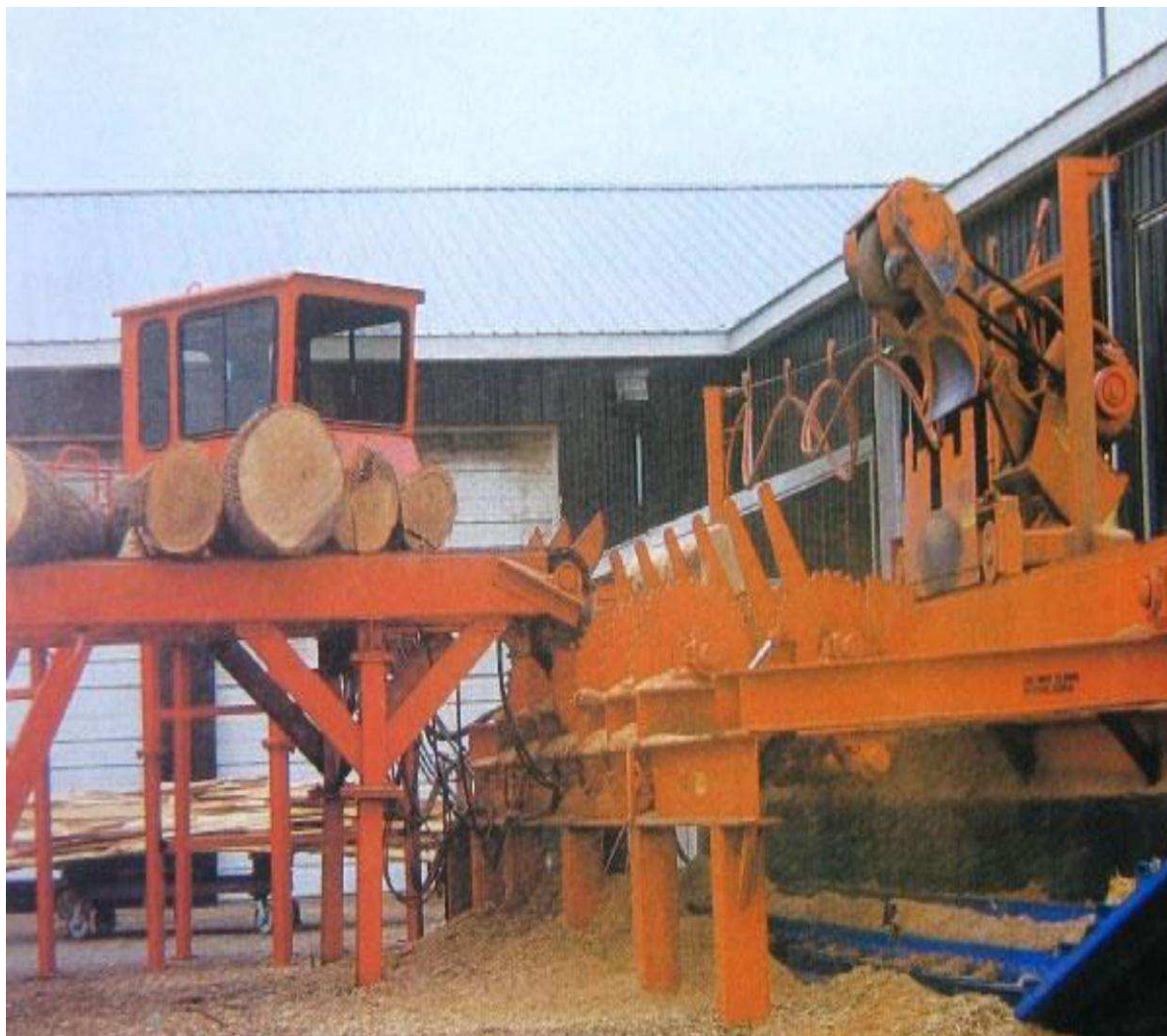
Рисунок 30 - Окорочный станок Morbark 648 Rosserhead
