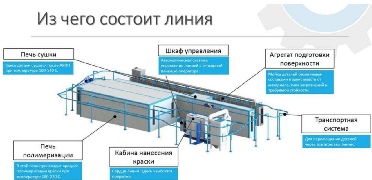
Рисунок 22 - состав линии для окрашивания щепы и крошки
