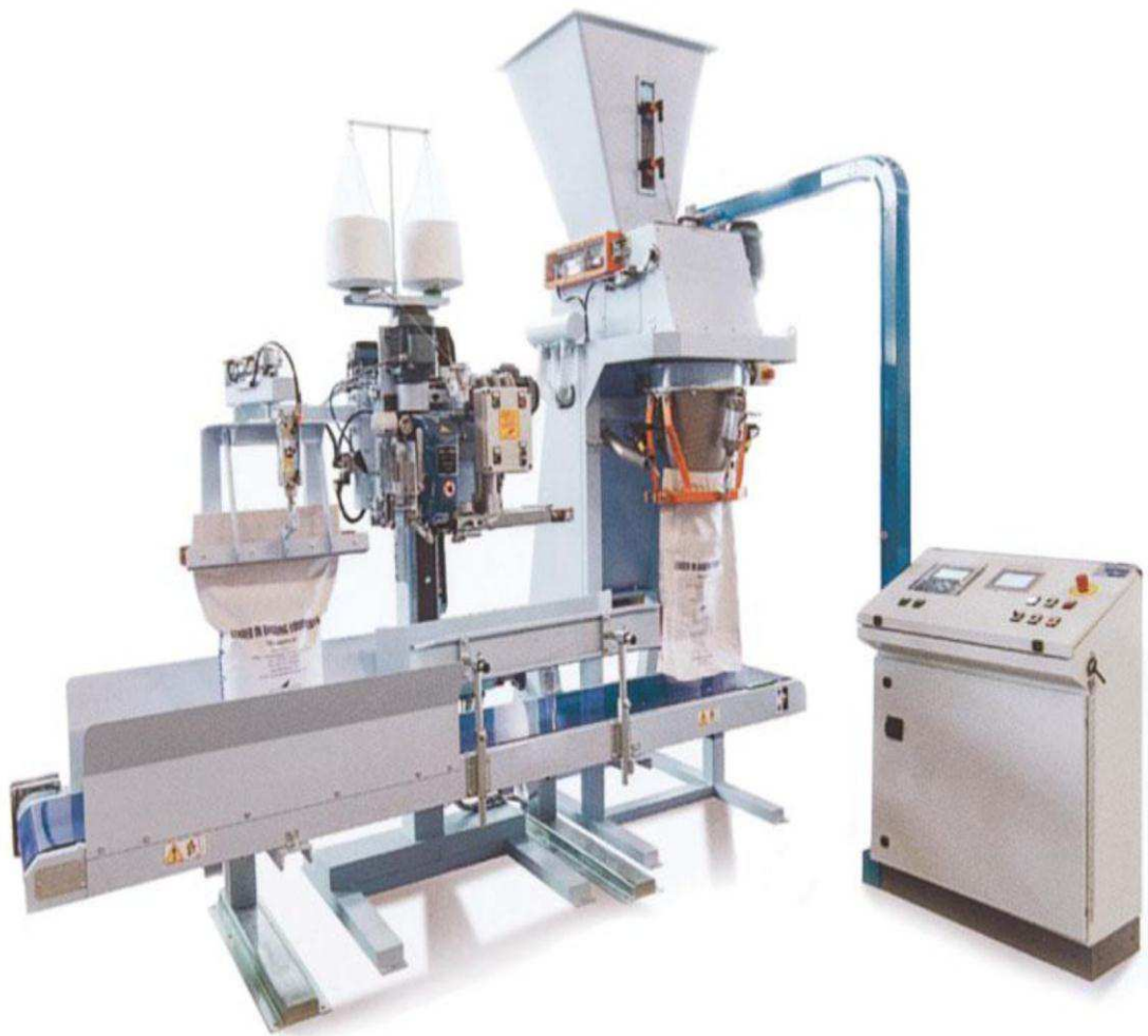
Рисунок 25 - полуавтоматический упаковщик щепы MORBARK MULTIBAGGER.
