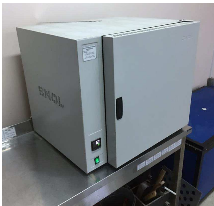
Рисунок 4 - Электрошкаф сушильный СНОЛ 58/350
