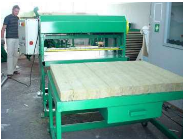
Рисунок 9 - Укладка ламелей в плиту
