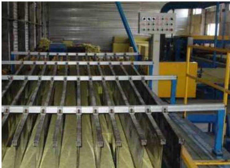
Рисунок 8 - Разрезка утеплителя на ламели (бруски)
