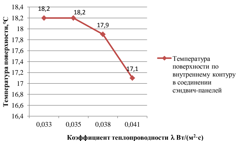
Рисунок 36 – График зависимости коэффициента теплопроводности от температуры внутреннего контура в стыке сэндвич - панелей
