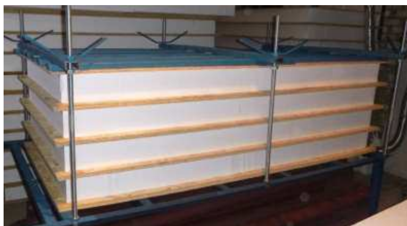
Рисунок 11– Выдержка сэндвич-панели под прессом
