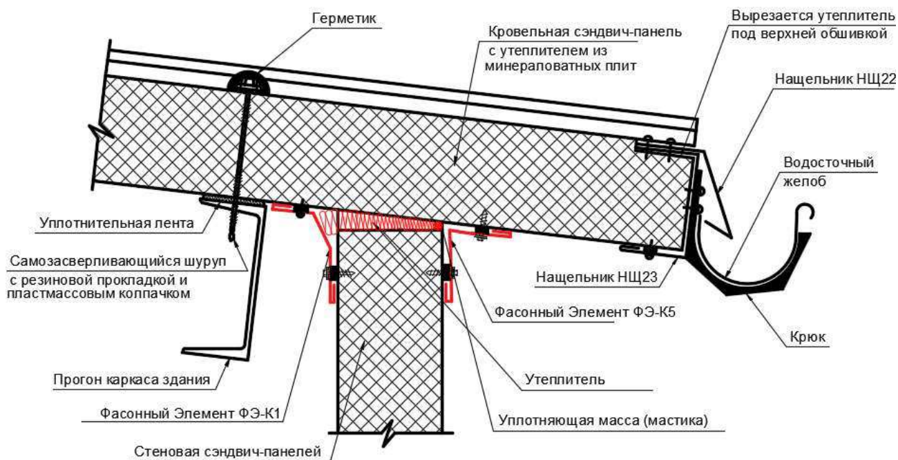
Рисунок 41 - Конструкция карниза при наружном решении водостока
