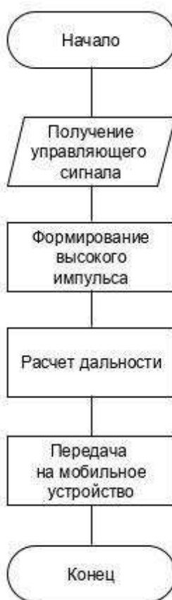
Рисунок 25 – Блок-схема определение дальности
