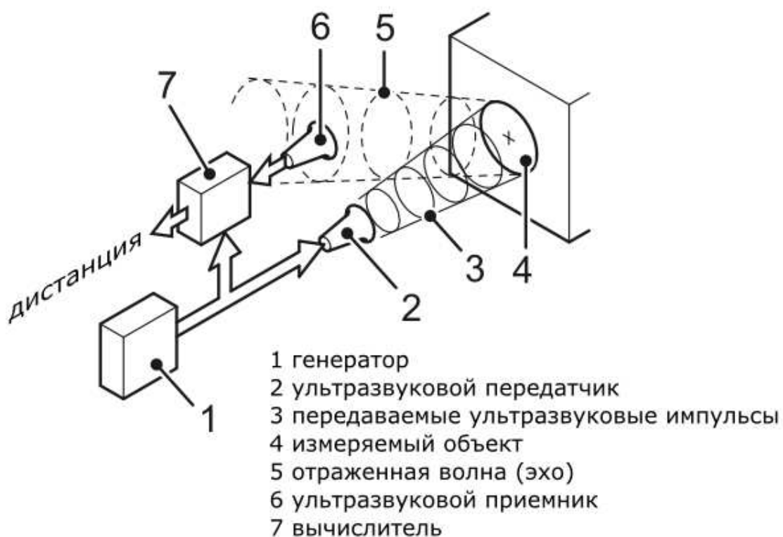
Рисунок 2 – Принцип действия ультразвукового дальномера
