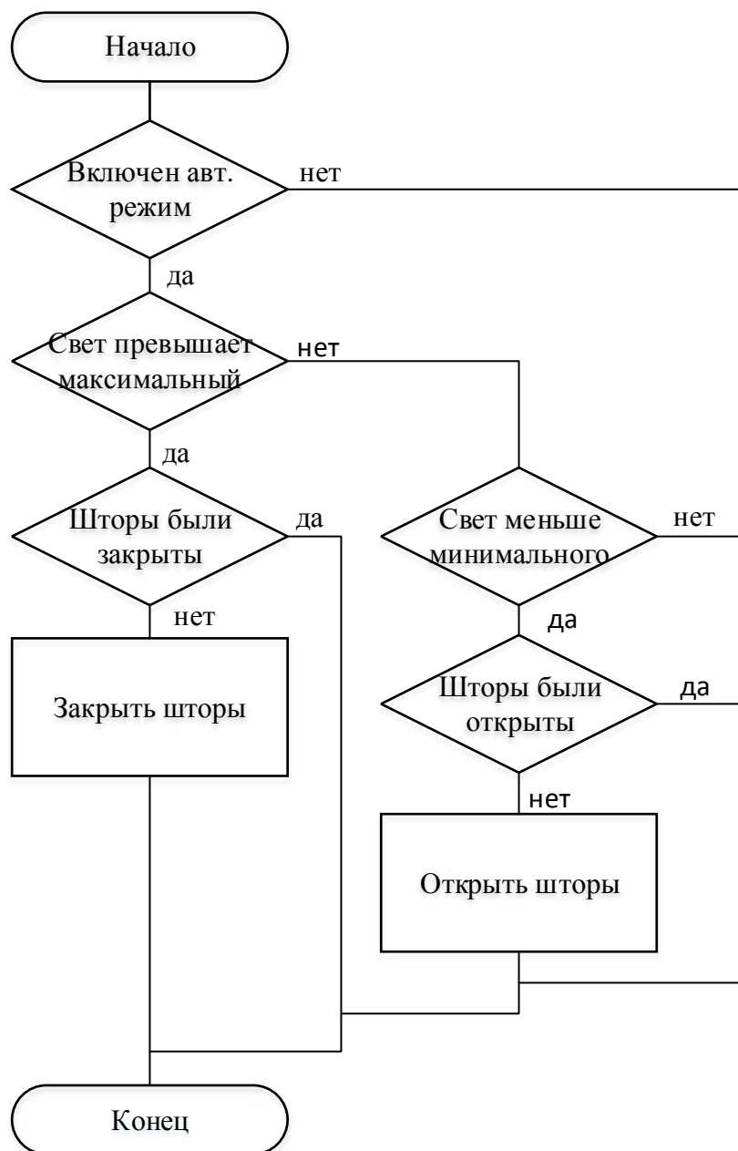
Рисунок 19 – Функция автоматического управления шторами
