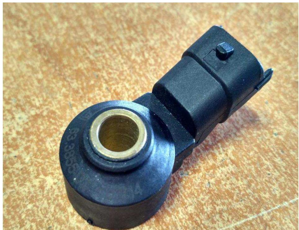
Рисунок 7 – Датчик детонации
