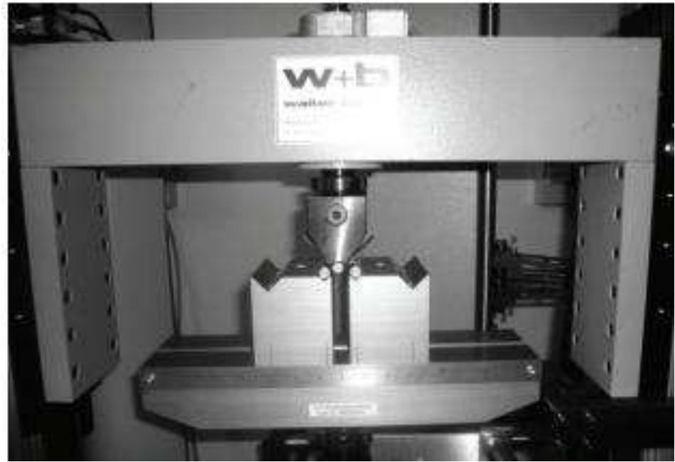
Рисунок 2.2 – Универсальная разрывная машина LFM 20 kN
