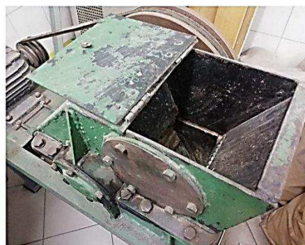
Рисунок 1 – Схема (а) и общий вид (б) щековой дробилки
