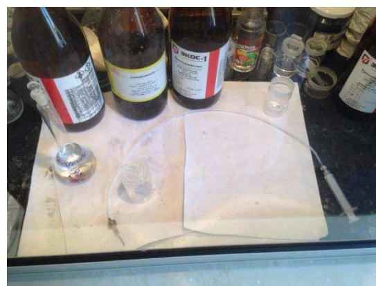
Рисунок 24 – Заливка растворенного полимера в шприц.
