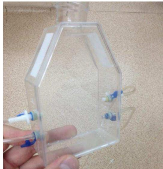
Рисунок 17 – Установленные коннекторы с резиновыми прокладками в емкости, в которой будет находиться полимер.
