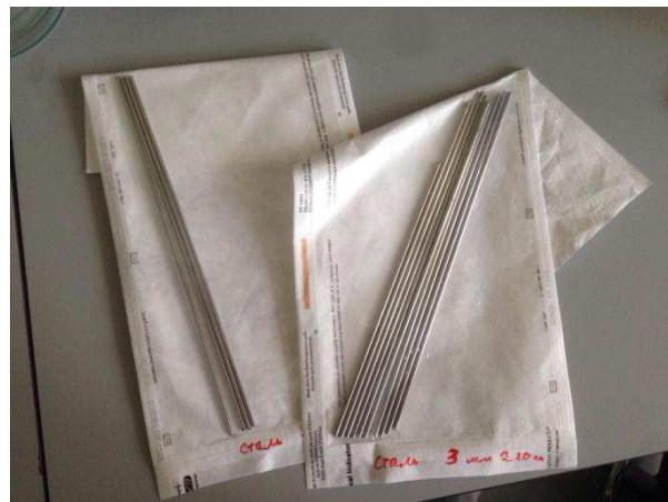
Рисунок 23 – Стальные мишени диаметром 2,4 и 3,2 мм.
