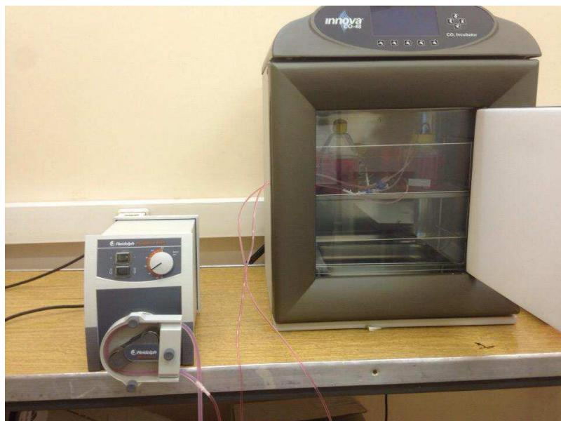
Рисунок 21 – Перфузационная культивационная система с полимерной трубкой и клеточной линией NIH 3T3.
