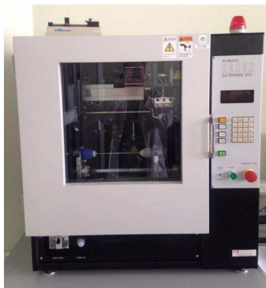
Рисунок 22 – Оборудование для электропиннинга “NANON-01A”.
