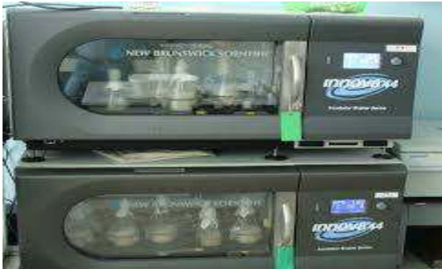
Рисунок 3. - Фото шейкеров-инкубаторов «Incubator Shaker Innova 44 для культивирования бактерий в колбах
