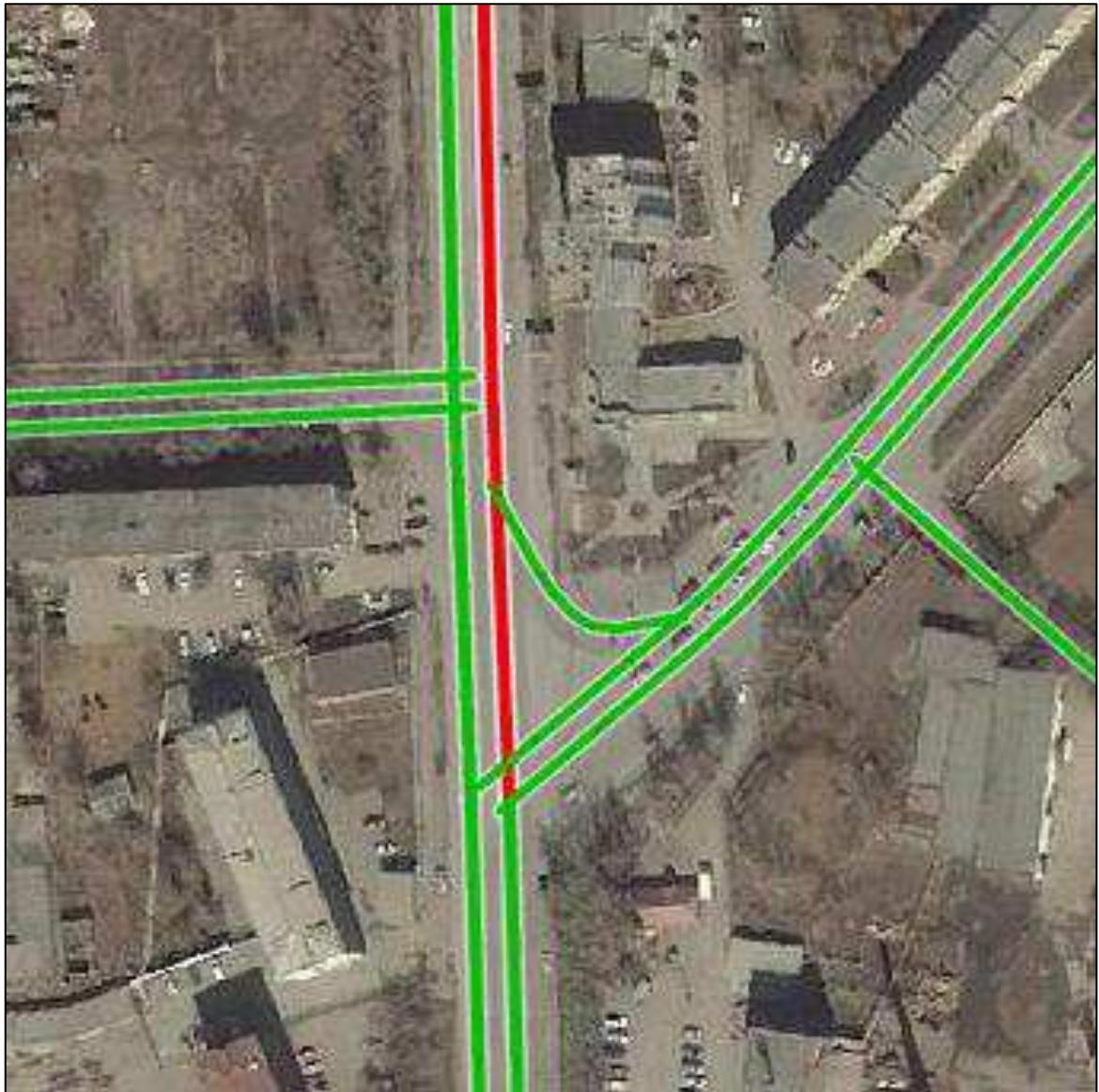
Рисунок 1.6 – Заторовые ситуации на участке УДС г. Ачинска на пересечении ул. Гагарина – ул. Лапенкова
