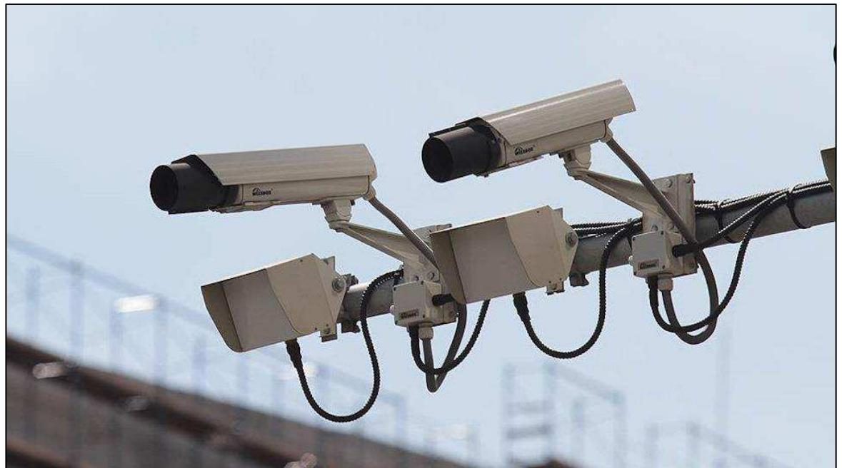
Рисунок 2.28 – Видеофиксатор нарушений ПДД АПК «АвтоУраган» - BCM
