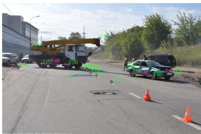
Рисунок 2.2 – Снимок места дорожно-транспортного происшествия, полученный с помощью аппаратно-програмного комплекса «Ракурс».
