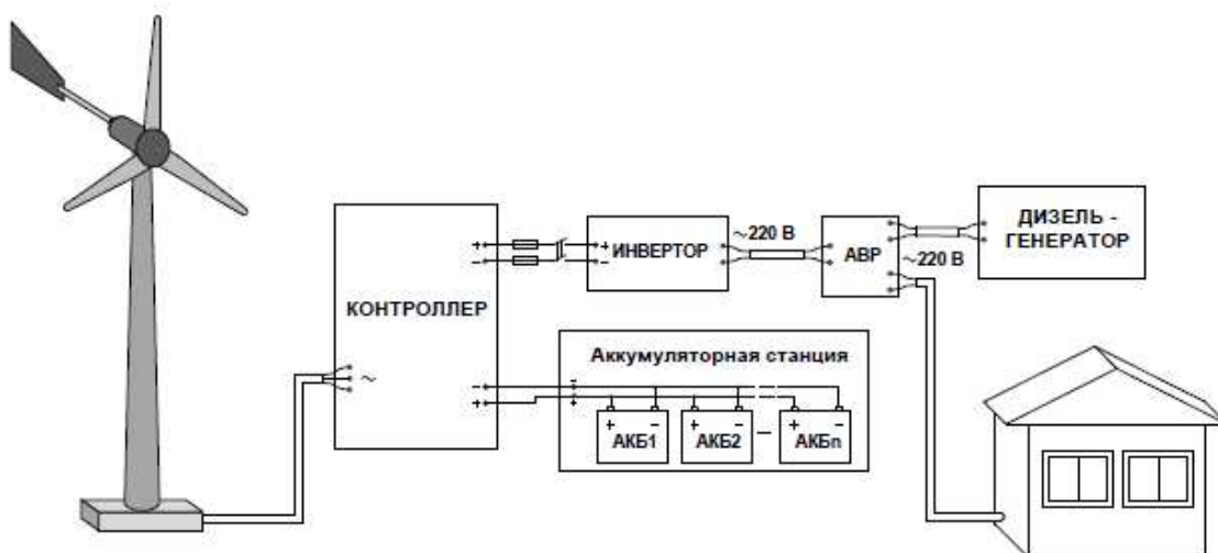
Рисунок 1.5 – Схема обеспечения электроэнергией с дизель-генератором.
