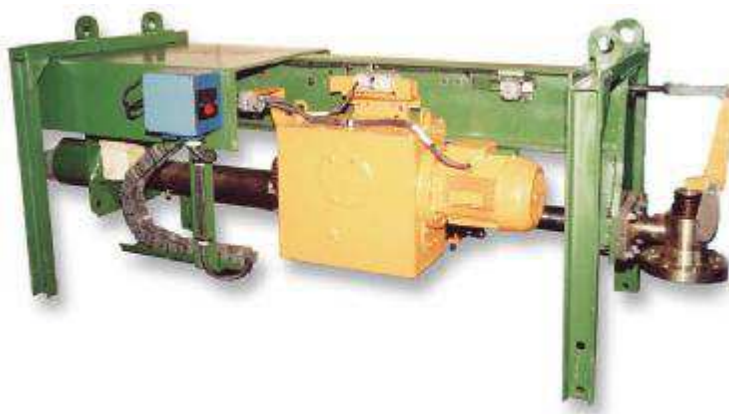
Рисунок 1.12 – Маловыдвижной аппарат паровой обдувки ОМП
